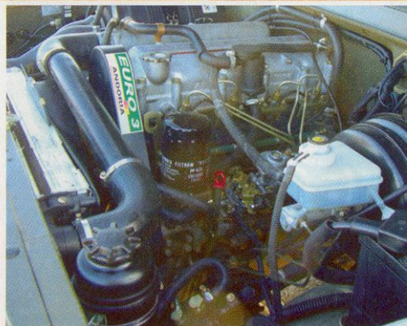
vlevo Čtyřválec Andoria dává slušných 75 kW
